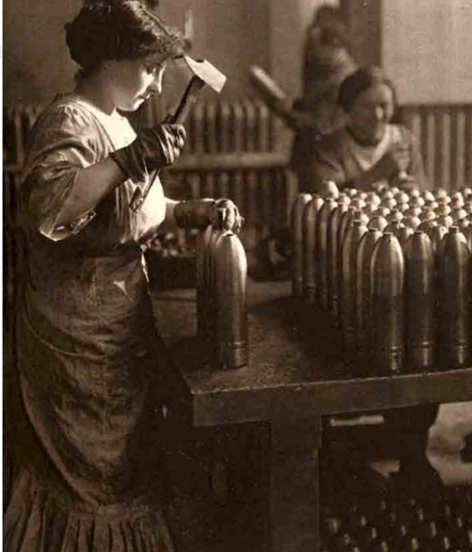
Munitionnettes chargeant des balles de shrapnell dans un obus fusant de 75 au cours de la Grande Guerre. © rosalielebel75.franceserv.fr
