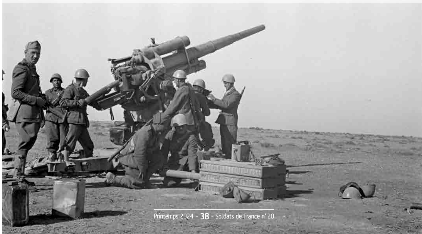
Un canon de 8,8 cm FlaK-18 utilisé par des artilleurs italiens en action. © Auteur inconnu/ECPAD/Défense.
