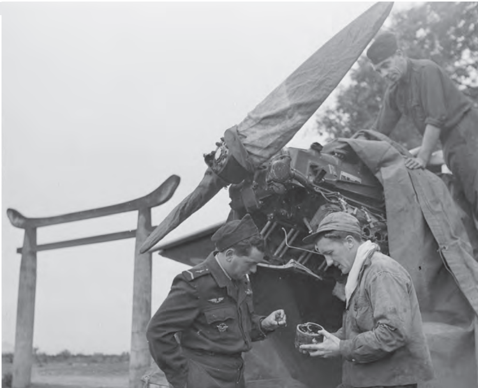
Réparation d'un avion d'observation Morane-Saulnier MS-500. © Auteur inconnu/ECPAD/Défense.
