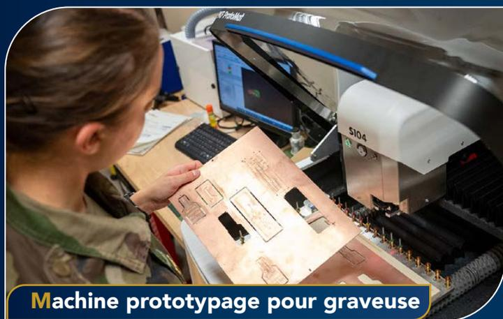
**Machine prototypage pour graveuse**
