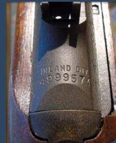
Les marquages présents sur le boîtier de culasse identifient d'une part le fabricant : *Inland division of general motors* et d'autre part le numéro matricule : 4999574.
